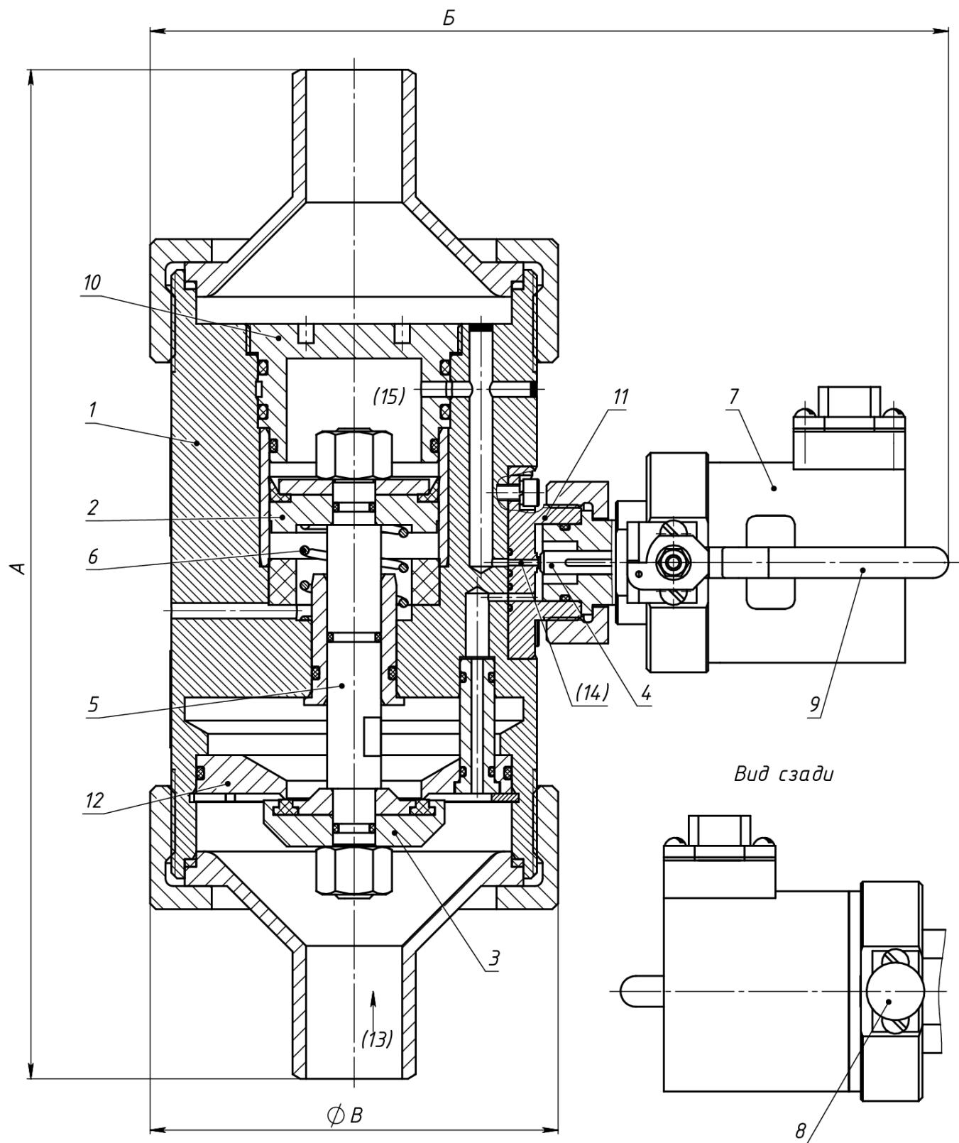
Рис. А.1 Конструкция распределительного устройства типа РУ-025-065-П(-ВЗ),
