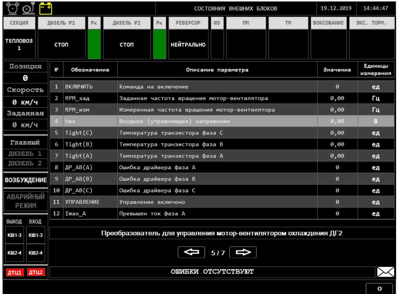
Рисунок 20 – Кадр СОСТОЯНИЯ ВНЕШНИХ БЛОКОВ
