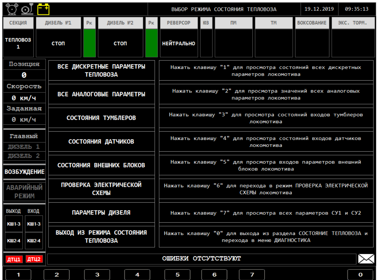
Рисунок 15 – Кадр ВЫБОР РЕЖИМА СОСТОЯНИЯ ТЕПЛОВОЗА в разделе ДИАГНОСТИКА
