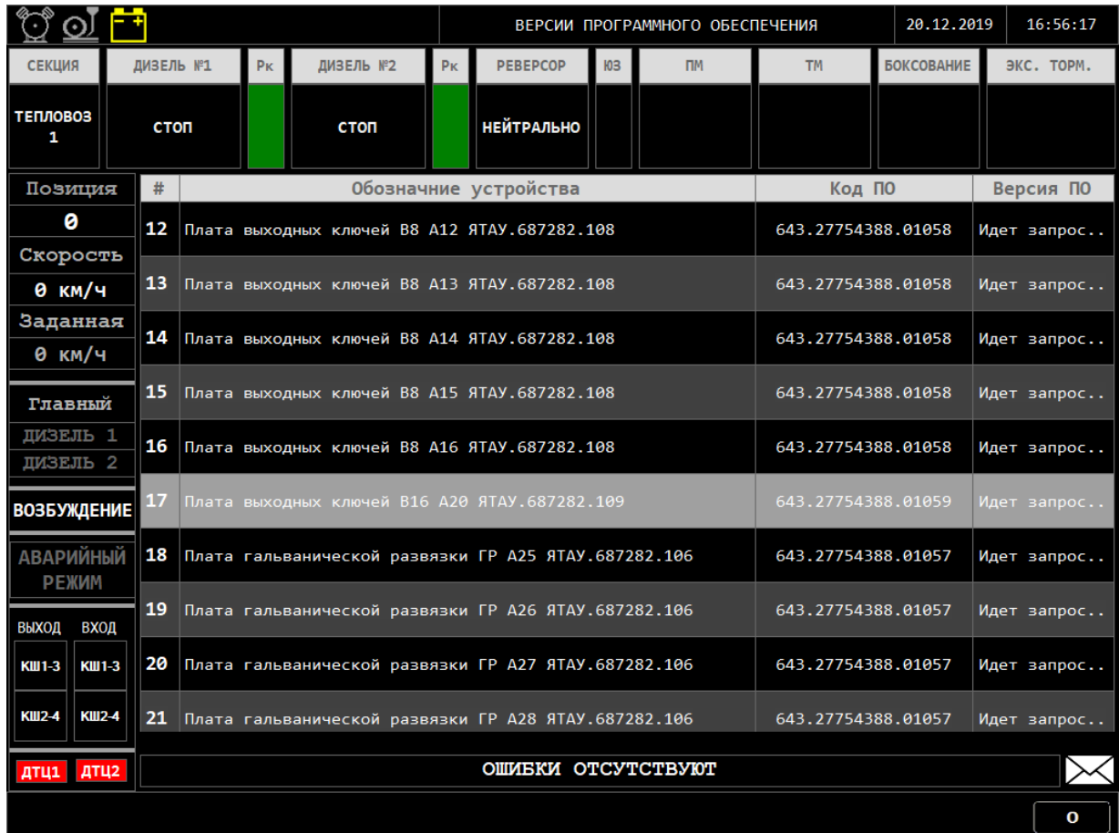
Рисунок 36 – Кадр ВЕРСИИ ПРОГРАММНОГО ОБЕСПЕЧЕНИЯ (Идёт запрос)
